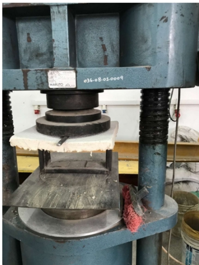
Prueba de flexión de panel de papel con yeso
