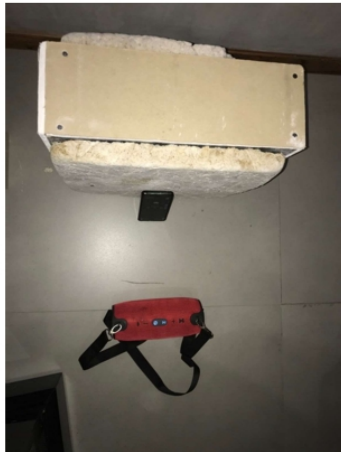
Prueba acústica en paneles
