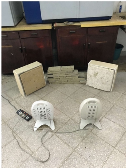
Prueba térmica de ladrillos y paneles
