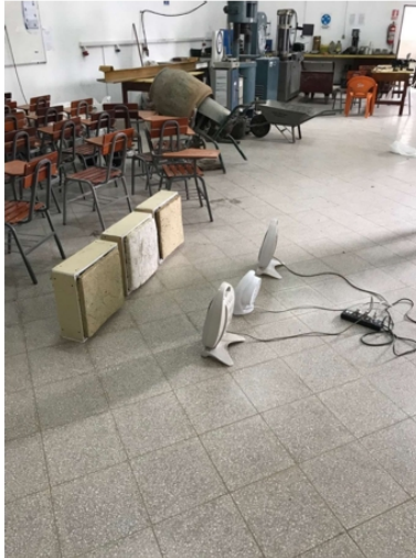
Prueba térmica de paneles
