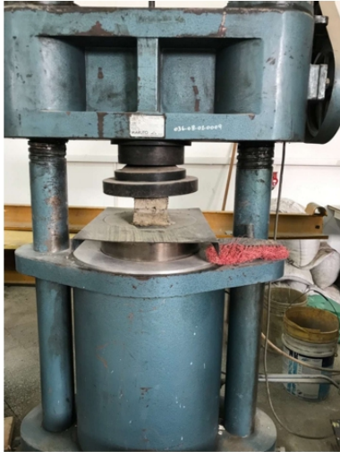
Prueba de compresión ladrillo de papel con cemento
