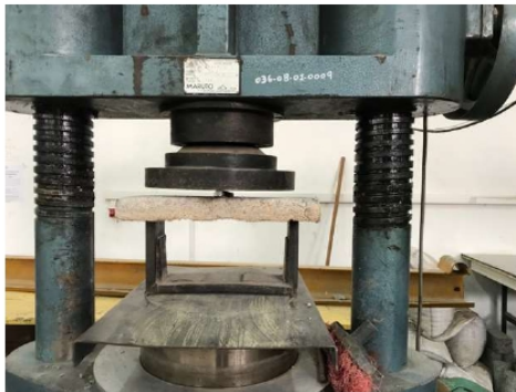
Prueba de flexión de panel de papel con plasticola
